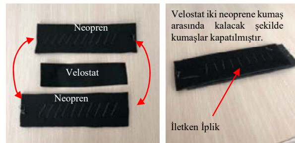
Şekil 4. Önerilen Sensörün Yapısı
